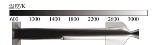
图4 无扰流板和 \epsilon_d = 2.0, \lambda_d = 0.5 工况的温度云图
